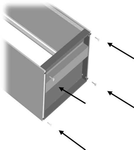
5.5. Установить комплект панелей задней стенки. Закрепить винтами самонарезающими к боковым стенкам и к днищу. Болтами – между собой (для комплекта, состоящего из двух панелей) и к крышке
