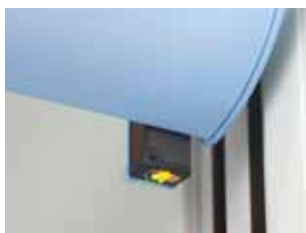
ИК-датчики на подвижном экране
