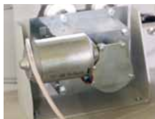
Механизм автоматизации подвижного экрана
