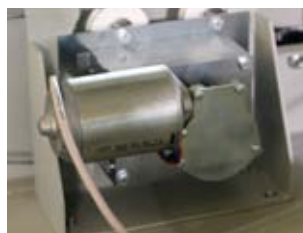
Механизм автоматизации подвижного экрана
